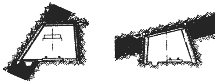
شکل ۲-۴- چوب‌بست در تونل دنباله‌رو
